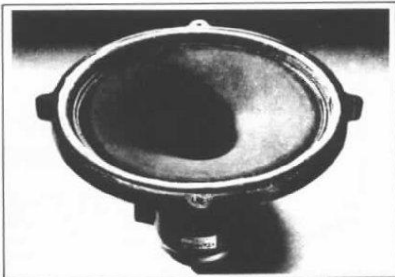
Première version du Dual Concentric de Tannoy (1947) en finition noire martelée. Remarque l'absence de dôme anti-poussière utilisée ultérieurement.
